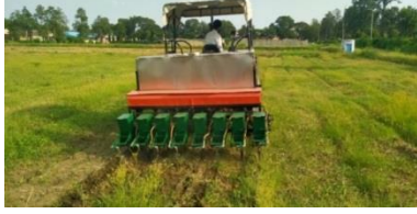
चित्र-1: जीरो टिल प्लांटर के साथ प्री-इमर्जेस हर्बिसाइड एप्लीकेटर (8 फरो ओपनर)
