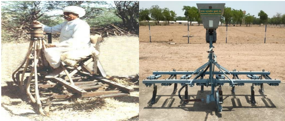
चित्र 1. पारंपरिक बीज बुवाई यंत्र और उन्नत पारंपरिक बीज बुवाई यंत्र का आलोकन
