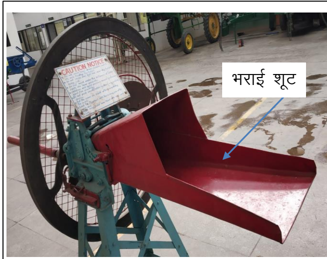
चित्र 2: (अ) चारा काटने की मशीन में उपयोग होने वाले कुछ सुरक्षा उपकरण (ब) चारा कटाई मशीन में ब्लेड के धारदार हिस्से से बचाने का गार्ड
