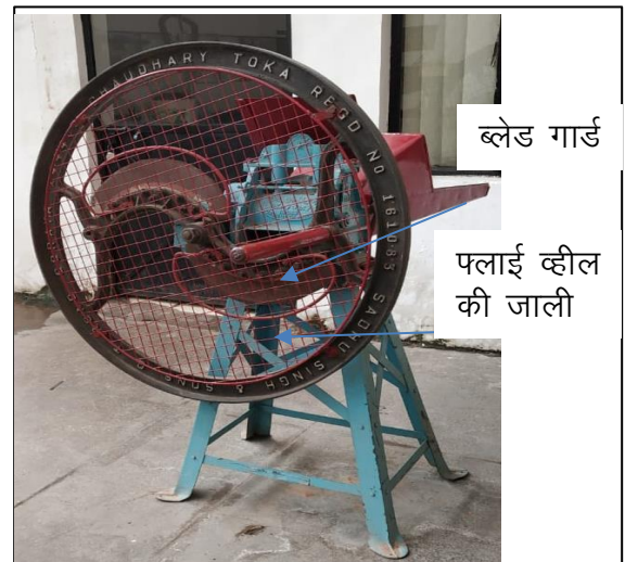
चित्र 2: (अ) चारा काटने की मशीन में उपयोग होने वाले कुछ सुरक्षा उपकरण (ब) चारा कटाई मशीन में ब्लेड के धारदार हिस्से से बचाने का गार्ड
